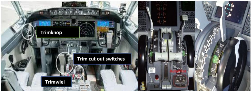
Figuur 6 B737 cockpit met Trimknop, Trim cut out switches en de trimwielen
