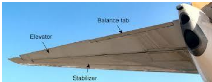
Figuur 5 Linker helft van het stabilo ("Stabiliser") met hoogteroer ("Elevator").
